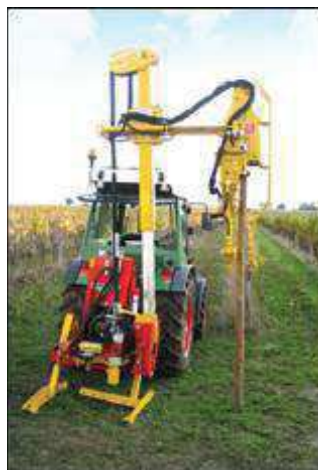
Photo : Exemple d'enfonce-pieux (source : Rabaud SARL)
